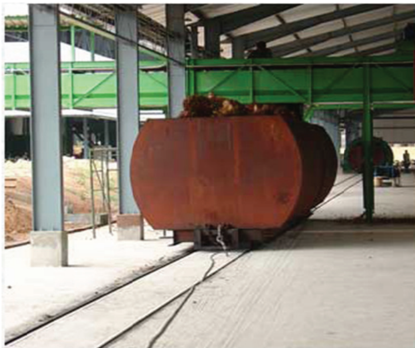
รูปภาพที่ 6 ลำเลียงผลิตผลปาล์มน้ำมันลงกระบะ (Ramp)
