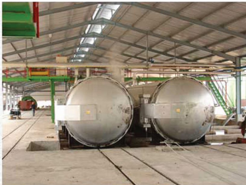
รูปภาพที่ 8 นึ่งผลิตผลปาล์มน้ำมันให้สุกด้วยไอน้ำ
