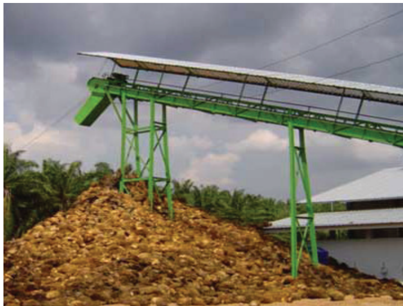
รูปภาพที่ 12 ลำเลียงทะลายนวลไปไว้ที่จุดรวบรวม (Empty bunch hopper) เพื่อรอจำหน่าย
