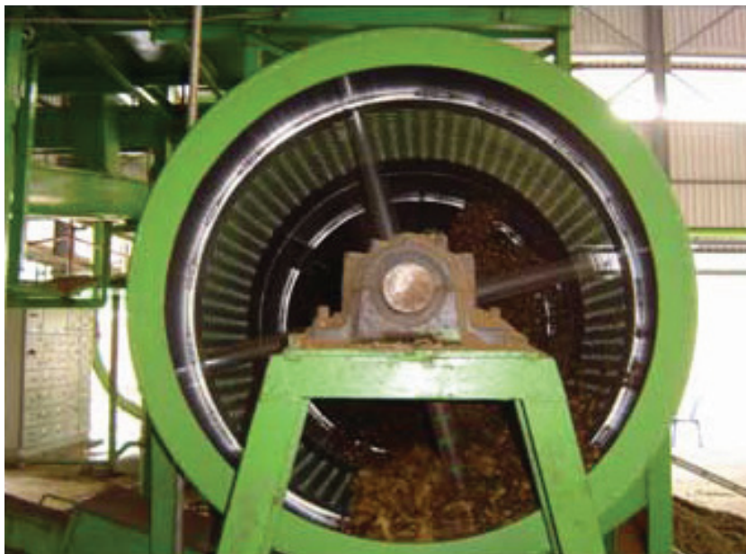
รูปภาพที่ 21 เครื่องแยกเส้นใยแยกเส้นใยออกจากเมล็ดปาล์ม
